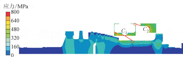
图 4 冷态启动过程中转子最大综合应力云图
