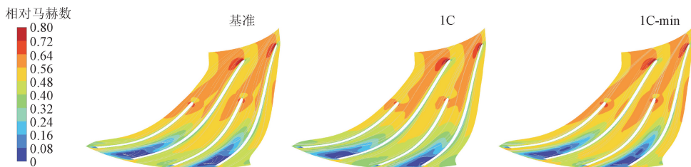
图12 近失速工况点 Q_m = 5.4 \text{ kg/s} 处 50%叶高相对马赫数和流线
