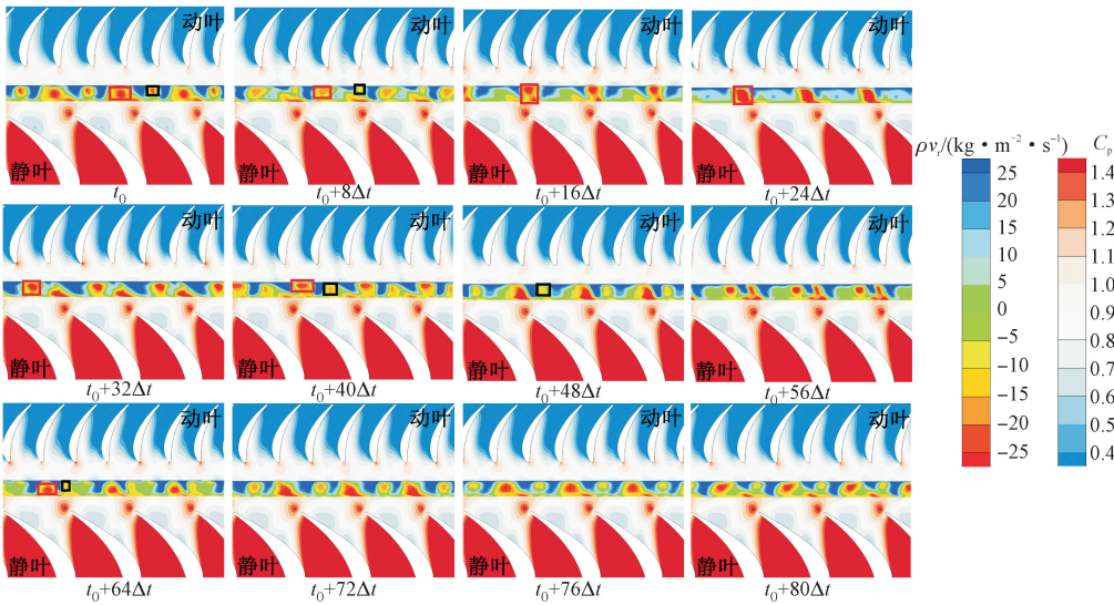
图 13 M_{FR} 为 0.22% 时动静叶下端壁无量纲静压和转静间隙单位面积径向质量流量随时间变化的分布云图 Fig. 13 Distribution of non-dimensional pressure on endwall and radial mass flux inside rim seal clearance when M_{FR}=0.22\%
