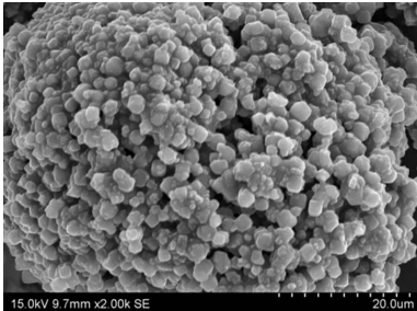
图 12 SHP 的微观结构 Fig. 12 Micro-structure of SHP
