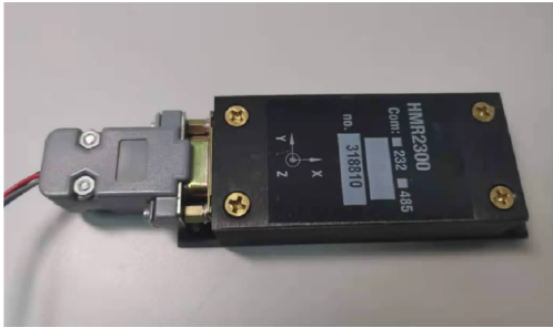
图 4 实验设备 Fig. 4 Experimental magnetometer
