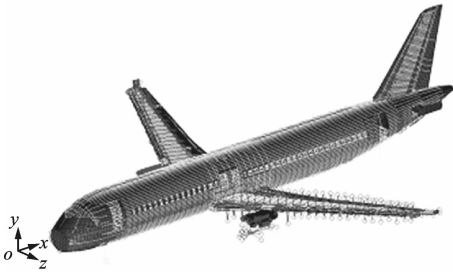
图 17 某型民用飞机全机有限元模型
