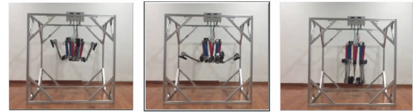
(a)完全收缩状态 (b)展开状态 (c)捕获目标状态 图 19 折展功能试验
