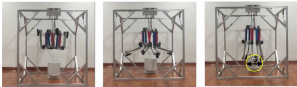
(a)完全收缩状态 (b)展开状态 (c)捕获目标状态 图 22 圆柱体捕获试验
