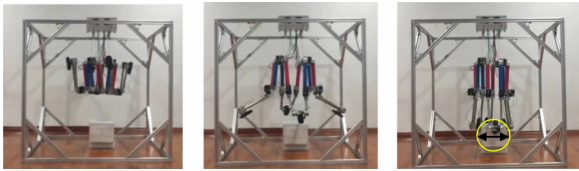
(a)完全收缩状态 (b)展开状态 (c)捕获目标状态 图 20 小立方体捕获试验
