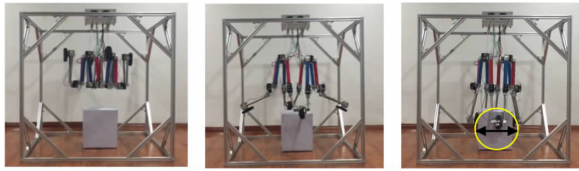
(a)完全收缩状态 (b)展开状态 (c)捕获目标状态 图 21 大立方体捕获试验
