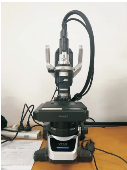
图 3 超景深三维显微系统 VHX-5000
