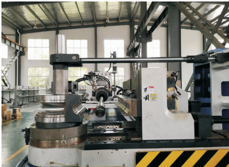
图 3 KM-A100-CNC-E120 数控弯管机
