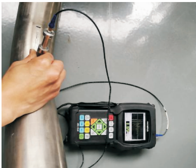
图 5 弯管试件壁厚测量
