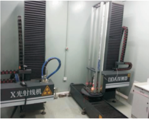
图 2 数字射线检测系统
