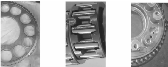
图 2 摆线轮点蚀 图 3 偏心轴磨损 图 4 行星架点蚀
