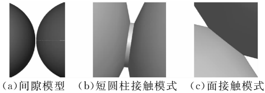
图 2 3 种接触模式示意图
