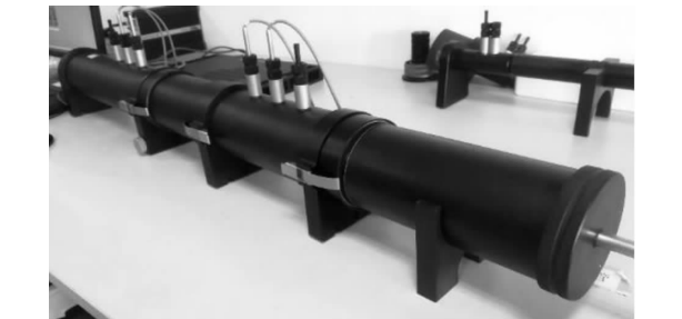
(c)Brüel & Kjær 4206-T 隔声实验系统 图 1 小尺寸 MAM 与 EVA 实验样件及隔声实验系统
