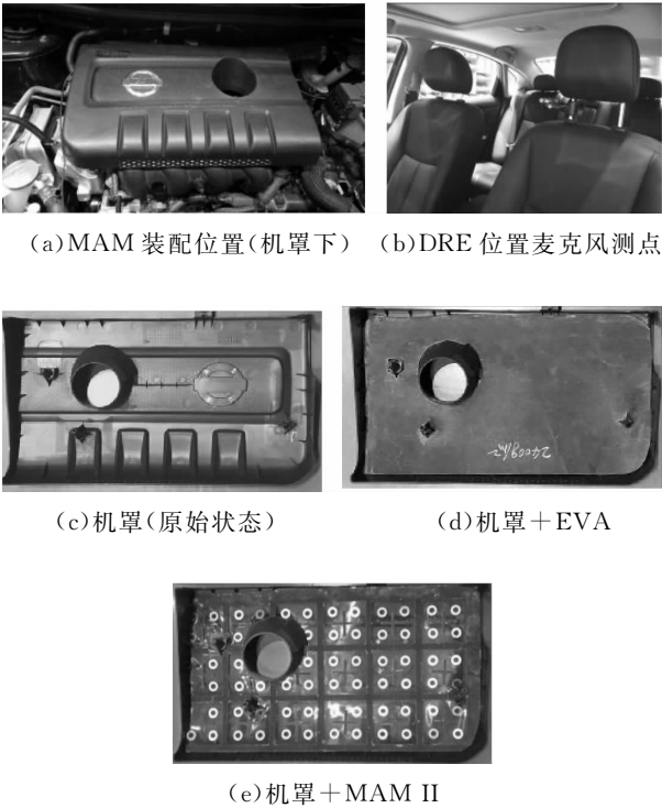
图 7 大尺度 MAM II 实车测试条件及样件装配状态
