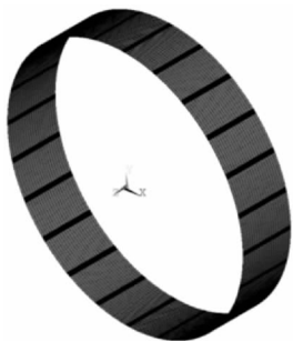
图2 轴承油膜网格划分模型
