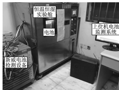
图1 电池测试平台
