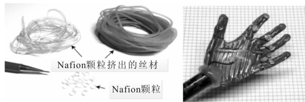
(a) 挤丝得到的 IPMC 线材
