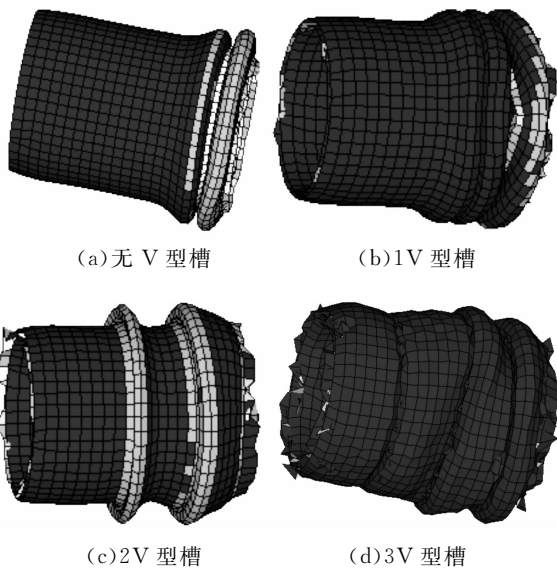
图 10 不同数目 V 型诱导槽吸能盒变形图
