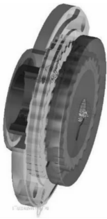
图 17 新型齿轮传动减速装置的动力学仿真模型
