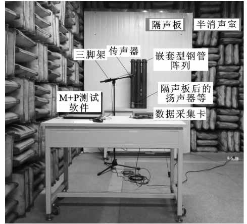
图 4 透射系数测试实验平台
