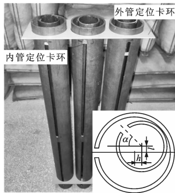
图1 嵌套型开缝管声子晶体单胞及实验样品
