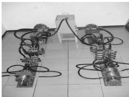
图4 多泵多速马达实物连接照片
