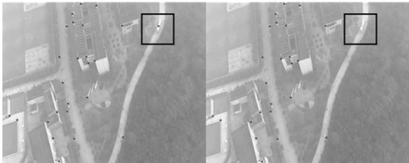
圆点为提取的特征角点;方框中行驶的汽车作为误匹配点被剔除 (a)提取特征角点 (b)剔除运动目标
