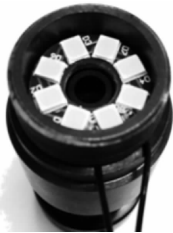
图 7 圆环形 LED 阵列反射光源实物图
