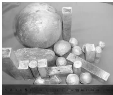
图8 采用二次发泡技术制备的各种异形件
