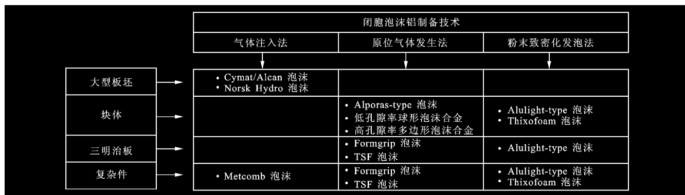
图9 各类闭孔泡沫铝的制备技术
