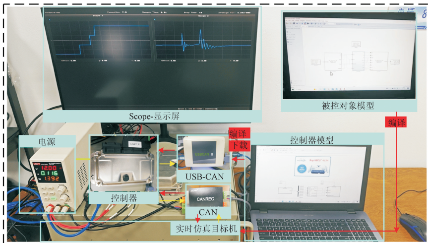
图 11 HIL 试验原理图
